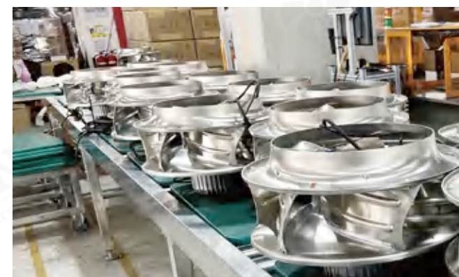
Production Line - Centrifugal Fan
