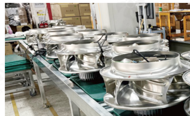
Production Line - Centrifugal Fan
