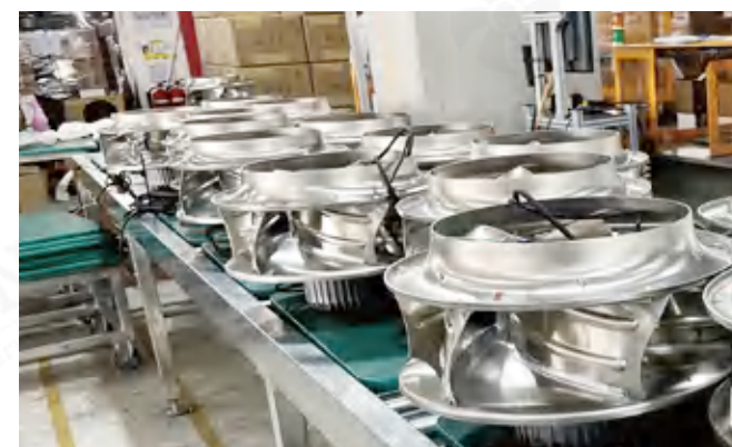
Production Line - Centrifugal Fan
